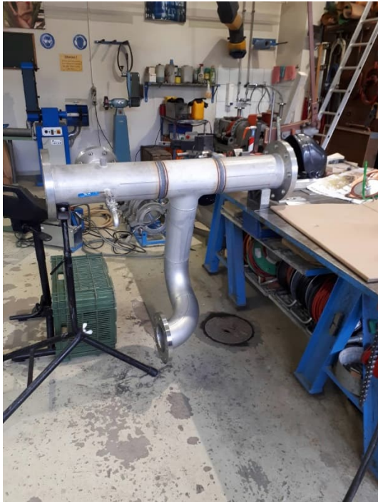
Réservoir Rosalys : façonnage nouvelle tubulure
